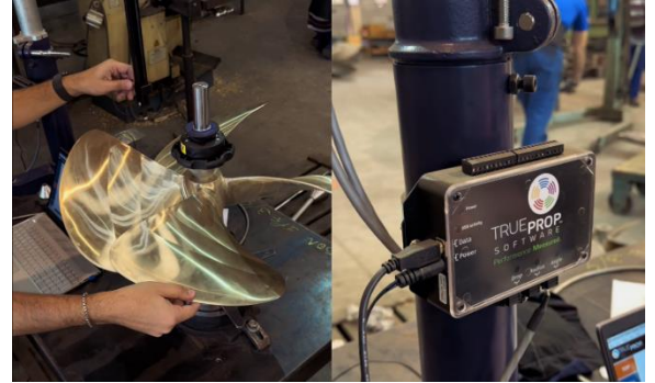
Figura 3: HELIX 48 es un sistema digital de medición de paso para hélices de hasta 48 pulgadas de diámetro.
